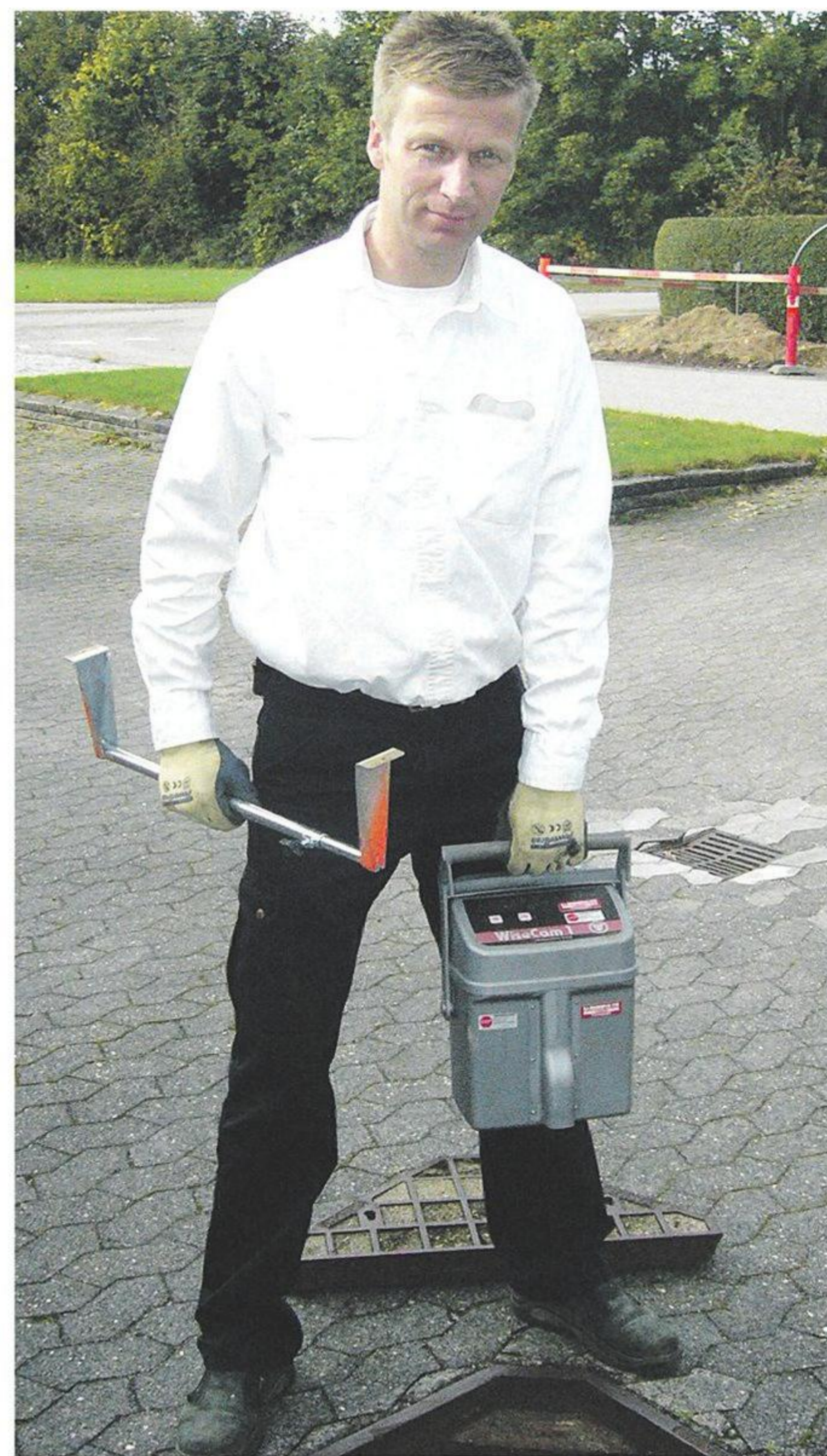
-kc Bent Hansen ses her med kameraet, som skal registrere om der er rotter i rørene i kloakken.
